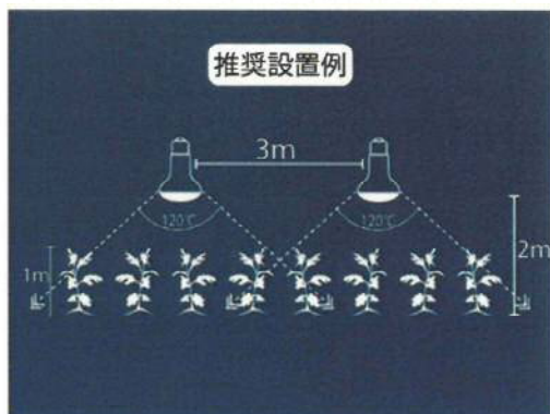
【設置推奨例】 間隔：3m 高さ：2m
